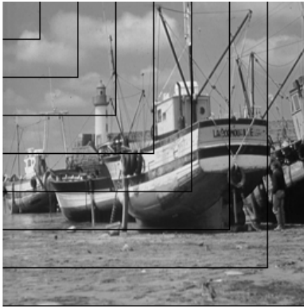
Slika 3.18: Slika 'Fishingboat', veličine 256x256 piksela, u prostornom domenu, i grafik porasta energije. Apscise predstavljaju dimenziju dela slike za koji se energija računa (kvadrata u gornjem levom uglu) (grafik desno predstavlja prikaz rasta energije slike sa porastom površine slike).
