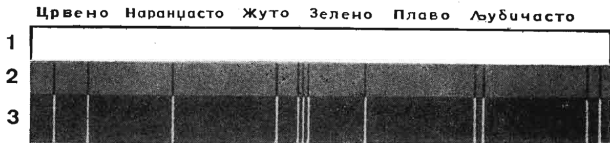
Слика 56. — Различити облици спектра: 1 — бела светлост; 2 — линијски апсорпциони спектар; 3 — линијски емисиони спектар
