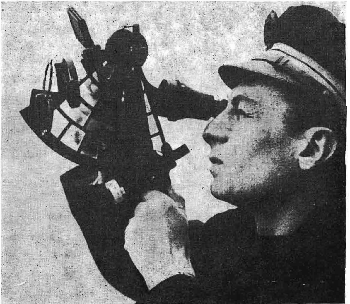
Сл. 35. а) Секстант; б) мерење висине небеског тела секстантом
