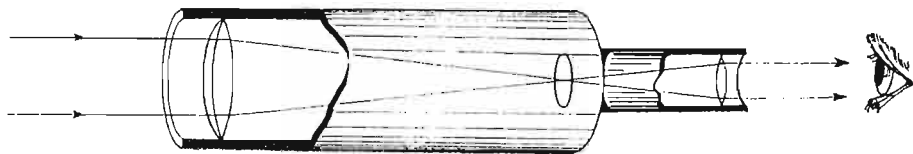
Сл. 5. Принцип рада телескопа
