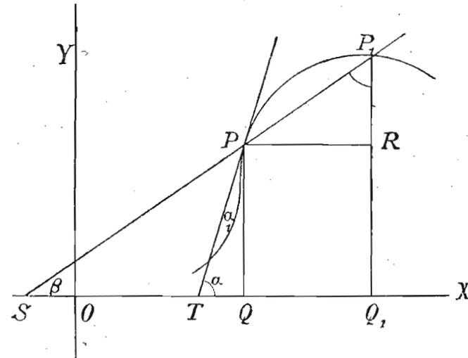
Der Differenzenquotient (1) oder (1\*) gibt das Steigungsmass der Sekante  $PP_1$  an, welche zu den Kurvenpunkten  $P = (x, y)$  und  $P_1 = (x + \Delta x, y + \Delta y)$  gehört.
