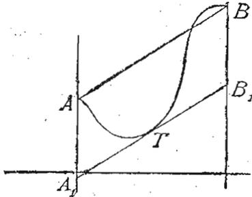
Aus dem Satze folgt: Wenn  $f(a) = 0$  und  $f(b) = 0$  ist, dann giebt es für  $f'(x) = 0$  eine Lösung, die zwischen  $x = a$  und  $x = b$  liegt.
