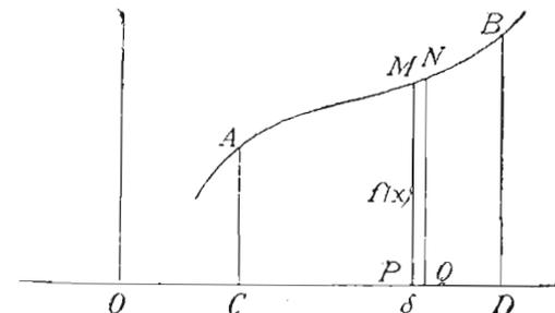
$CD = (b - a)$  in  $n$  gleiche Teile, deren Größe  $\delta$  sein mag, und errichten in allen Teilpunkten Ordinaten. Dadurch wird die Fläche in  $n$  Streifen zerlegt, wie  $MNQP$ , deren Inhalt bei hinlänglich kleinem  $\delta$  gleich dem Produkte aus  $\delta$  und der zugehörigen Ordinate gesetzt werden kann. Ist also  $y = f(x)$  die Gleichung der Kurve, dann entsteht für die Fläche nach (15), S. 173, der Wert
