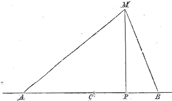
gegeben; man soll den geometrischen Ort aller Punkte  $M$  finden, die so liegen, dass das Produkt der beiden Leitstrahlen  $MA$  und  $MB$  konstant ist. Für  $MA = r$ ,  $MB = r_1$  muss  $r \times r_1 = a^2$  sein.  $CA = CB = e$ ;  $CP = x$ ,  $MP = y$ ;  $[y^2 + (e + x)^2][y^2 + (e - x)^2] = a^4$ ;  $(y^2 + x^2)^2$
