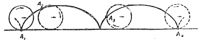
Сл. 111. Циклоида — путања тачке A на кружној линији која се котрља без клизања по правој линији
