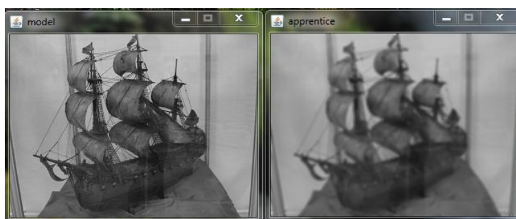
Slika 37: primena naučenog filtera blur na novoodabranu sliku
