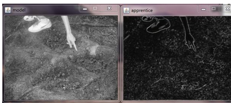
Slika 31: primena naučenog Sobel filtera detekcije ivica na novoodabranu sliku
