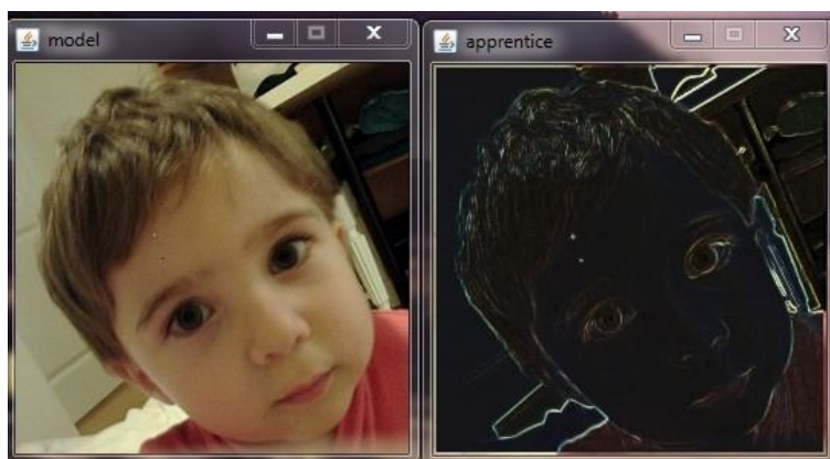
Slika 34: primena naučenog filtera glowing edges na novoodabranu sliku
