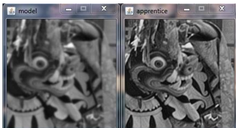
Slika 41: primena naučenog filtera deblur na novoodabranu sliku
