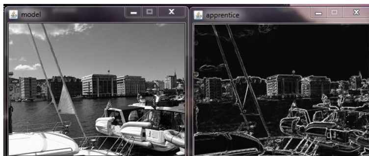
Slika 32: primena naučenog Sobel filtera detekcije ivica na novoodabranu sliku
