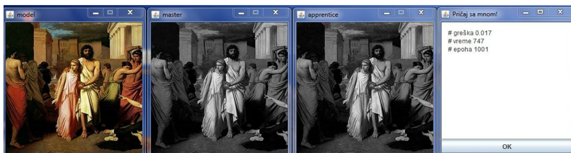
Slika 17: rezultat učenja filtera koji konvertuje sliku u boji (model) u grayscale sliku (master) prikazan je u prozoru apprentice
