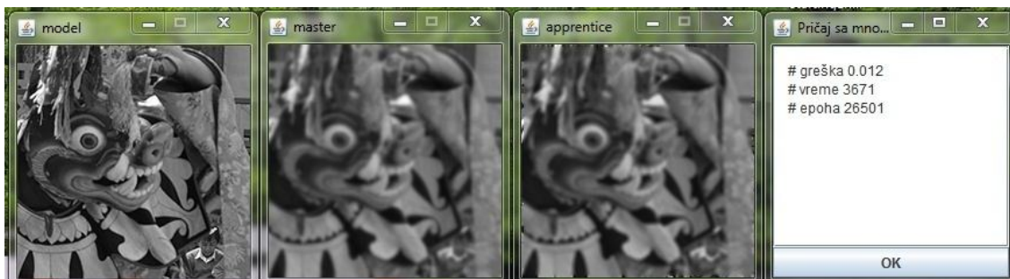
Slika 36: rezultat učenja Photoshop -ovog filtera blur ( master ) za odabranu originalnu sliku ( model ) prikazan je u prozoru apprentice
