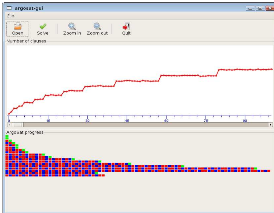
Slika 11.7: Grafički korisnički interfejs rešavača ArgoSAT. Gornji panel prikazuje grafik na kome se vidi broj tekući broj klauza nakon svake primene zaboravljanja, dok donji panel prikazuje primenjena pravila prelaska (kodirana različitim bojama). Sa grafika se jasno očitava MiniSAT strategija zaboravljanja koja nakon svake primene pravila Restart uvećava dopušteni broj klauza u sistemu.
