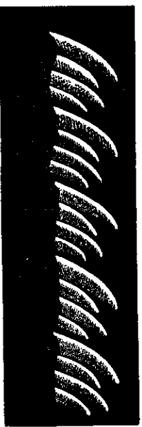
Fig. 706. Flammenbild im Dreispiegel, mehrere Obertöne ansetzend.
