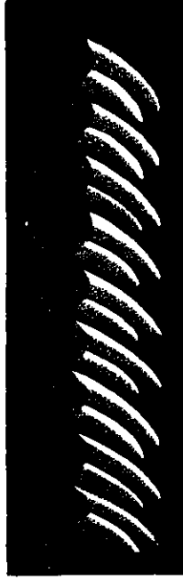
Fig. 704. Flammenbild im Dreispiegel, den ersten Oberton zeigend.
