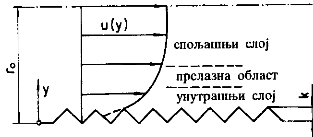
Сл. 1. Схема структуре потпуно развијеног турбулентног струјања у цеви
