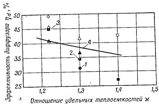
Фиг. 8. Вычисленные значения эффективности моделей выхлопных диффузоров, применявшихся с профилированным соплом, \epsilon = 20,3 . Затусшеванные значки обозначают величину эффективности при «минимальном» запуске; незатусшеванные значки обозначают величину эффективности на «минимальном» рабочем режиме. \circ — диффузор с конфигурацией 1, L/D = 13,6 ; \Delta — диффузор с конфигурацией 2, D_0/D_2^* = 1,422 , \bar{\kappa} \approx 1,3 ; \square — диффузор с конфигурацией 3А. 1 — также значение эффективности при «минимальном» рабочем режиме диффузора с конфигурацией 1; 2 — также значение эффективности при «минимальном» рабочем режиме диффузора с конфигурацией 3; 3 — также значение эффективности при «минимальном» пусковом режиме диффузора с конфигурацией 3А и значение эффективности при «минимальном» рабочем режиме диффузора с конфигурацией 3; 4 — эффективность, рассчитанная по теории прямого скачка уплотнения, расположенного в выходном сечении сопла.
