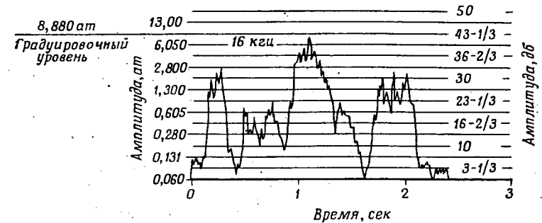
Ф и г. 6. Результаты амплитудно-временного анализа, полученные с трех отдельных 1/3 -октавных полосовых фильтров.
