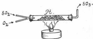
Sl. 37. Dobivanje sumpornog tri- oksida »kontaktnim« načinom s pomoću crnog platinskog praška koji se nalazi na asbestu. Laboratorijski ogled.
