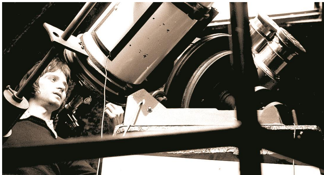
Слика 9: Касегрен-Њутнов рефлектор 215/4300 mm (лево) и двоструки астрограф 83/375 mm (десно) на заједничком стативу. Рефлектор је служио за визуелну контролу положаја објекта који се астрографом снима.
