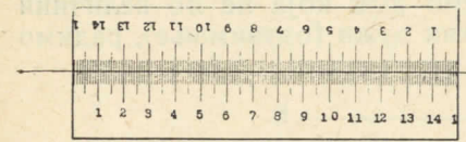
Сл. 31. — Испитивање исправности лењира.
