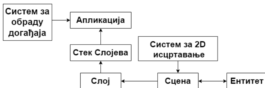
Слика 3.1: Приказ архитектуре погона Stormlight
