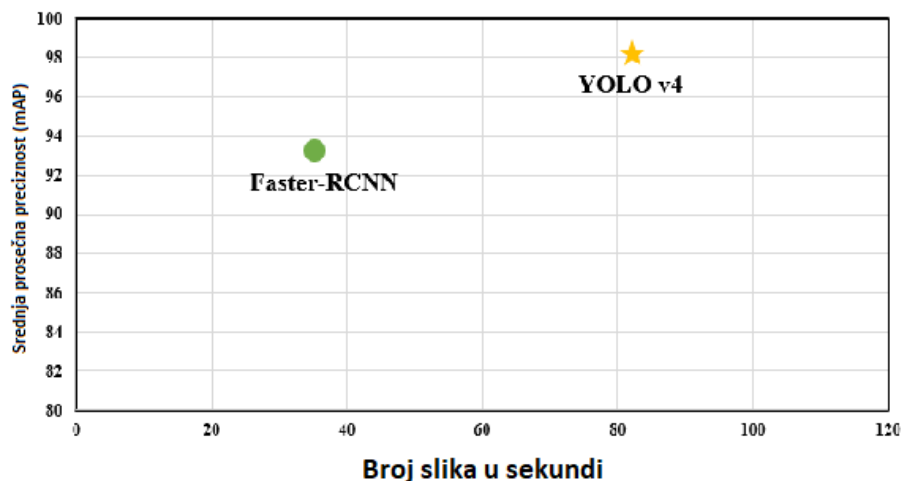
Slika 2.2: Poređenje modela YOLO sa modelom brži R-CNN [24]. Na y osi je prikazana metrika srednje prosečne preciznosti koju modeli ostvaruju, dok x osa predstavlja broj slika koji modeli mogu da obrade u sekundi.
