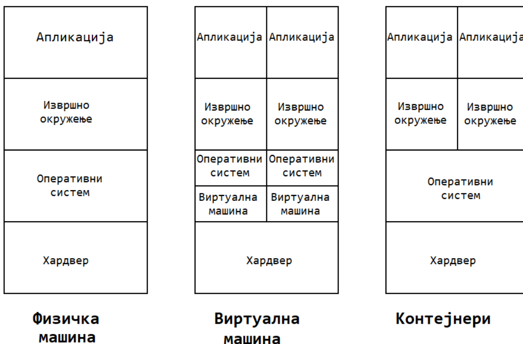
Слика 1.4: Упоредни приказ физичке, виртуалне машине и контејнера
