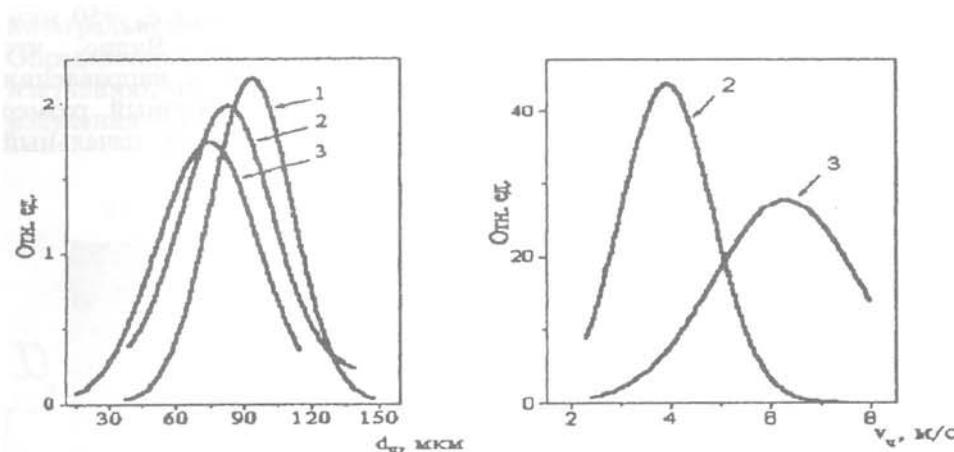
Рис.3. Распределение частиц КДФ по размерам и скоростям.
