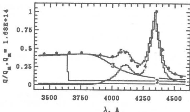
Рис.1. Коэффициент излучения водорода с параметрами  $T = 16250 \text{ K}$ ,  $N_e = 1.7 \cdot 10^{17} \text{ см}^{-3}$ . 1 - тарговое излучение; 2 - интегральный идеальный спектр; 3 - интегральное излучение с учетом растворения линий и диплороговой рекомбинации; 4 - излучение спектральных линий с учетом их растворения; 5 - полный коэффициент излучения. \* - эксперимент (Behringer).
