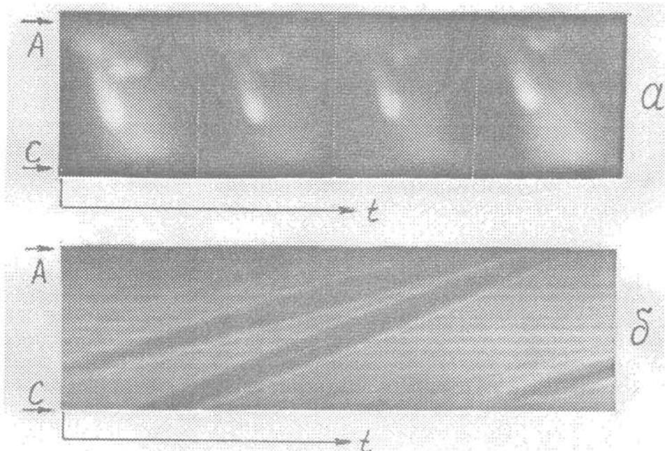
**Рис.2.** Скоростная киносъемка излучения частиц (а) (время экспозиции кадра 1 мкс, расстояние между кадрами 50 мкс) и непрерывная регистрация дифракционного изображения частиц (б). Стрелками А и С указаны положение анода и среза катодного сопла соответственно.
