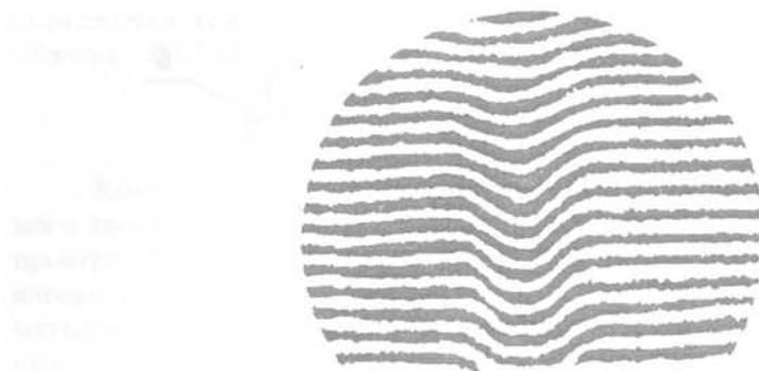
Рис. 2. Типичная интерферограмма компрессионного потока КСПУ.
