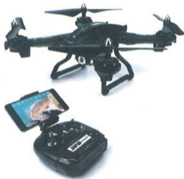
Слика 11. Мала БПЛ са четири хеликоптерска ротора (квадрајор)
