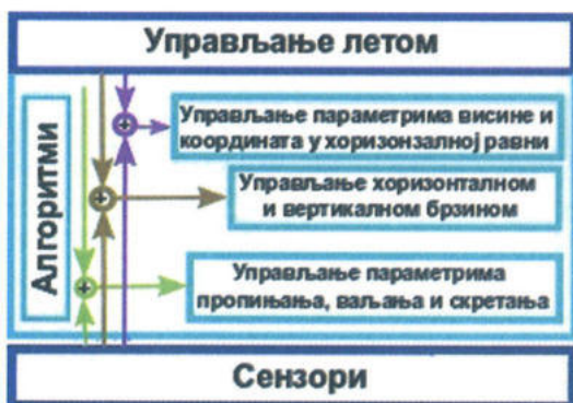
Слика 45. Типична шема за ујрављање летом БПЛ аутопилотом
