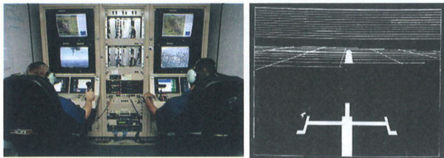
Слика 52, лево: Станица за управљање са БПЛ; десно: са приказивачким екранима и даљинска синтетичка кабина летелице ХиМАТ
