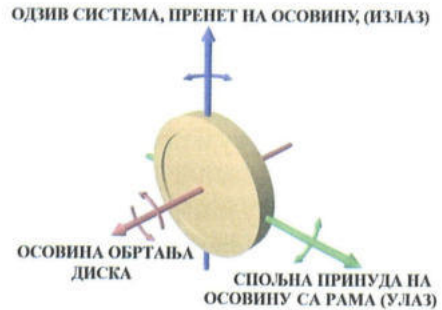
Слика 19, лево: Принцип рада механичкој жироскопи са карданским механизмом, са три слободна јрсијена; десно: Принцип одзива механизма жироскопи на спољну јрринуду
