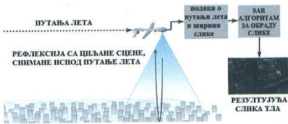
Слика 29. БПЛ са SAR-ом њрелеће њло у ѡренуику снимања.
