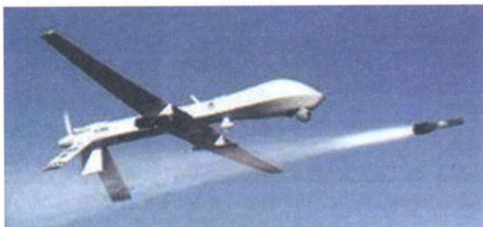
Слика 4. Амерички MQ-1 џредатор, лансира ракету ваздух-земља AGM-114 хелфајер.
