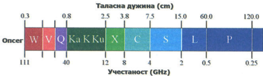
Слика 27. Активни сензор SAR користи микроваласни ојсе у широком радио-спектру.
