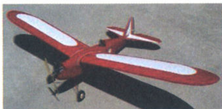
Слика 81. Модел авиона њојоњен клијно-елисним њојоном и ујрављан радио-сијналима (RC) ојтворео је еру беспилојној лејшења.
